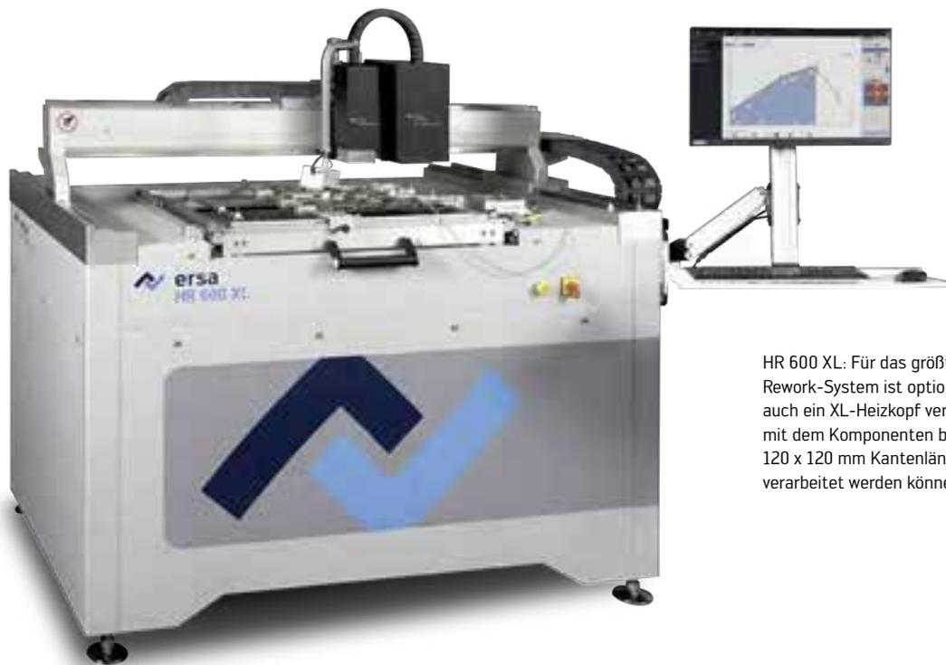
HR 600 XL: Für das größte Ersa Rework-System ist optional auch ein XL-Heizkopf verfügbar, mit dem Komponenten bis 120 x 120 mm Kantenlänge verarbeitet werden können
