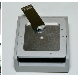
Dip&Print Station mit "MLF32"-Schablone
